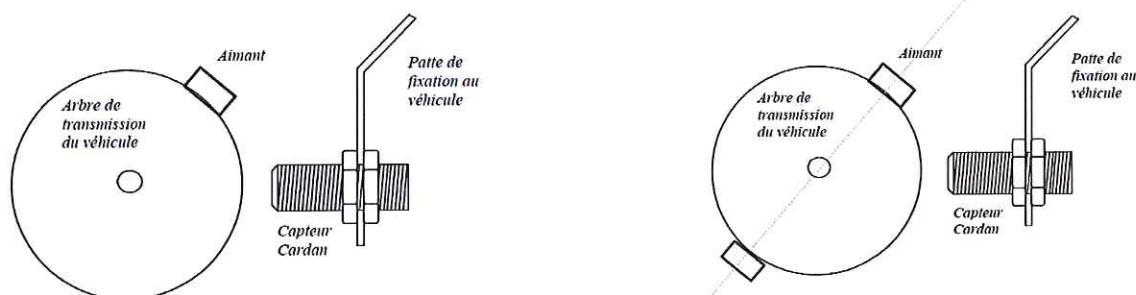
La distance maximale entre les aimants solidaires de l'arbre de transmission et le corps fixe du capteur est de 10 mm.
