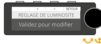
3 Tournez la molette dans l'un des deux sens jusqu'à obtenir « RÉGLAGE DE LUMINOSITÉ » puis appuyez sur le bouton central pour valider.
