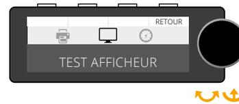
3 Tournez la molette dans l'un des deux sens jusqu'à obtenir « TEST AFFICHEUR » puis appuyez sur le bouton central pour démarrer le test.
