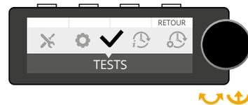
2 Tournez la molette dans l'un des deux sens jusqu'à obtenir « **TESTS** » puis appuyez sur le bouton central pour valider.
